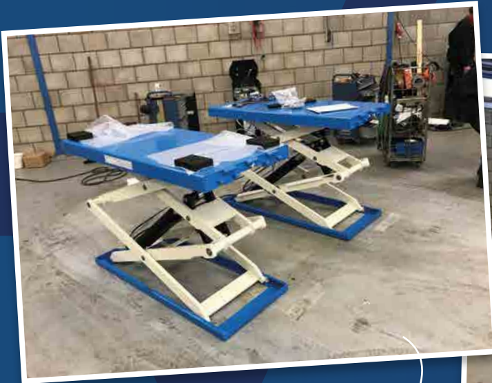
Vier extra bruggen geplaatst
